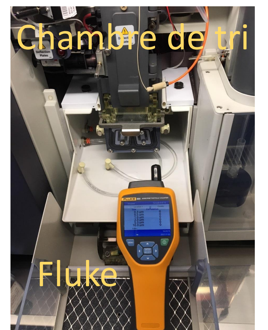
Image 1 : système Fluke de mesure des microparticules contenues dans l'air.
